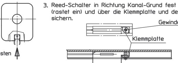
Bei der Montage des Reed-Schalters im Bereich der Klappkonsole ist die Kabelhalterung des Reed-Schalters abzutrennen.
