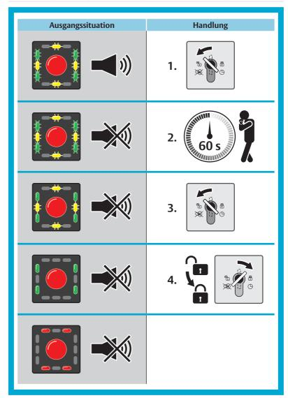
Je nach Ursache der Störung wird automatisch ein Funktionstest durchgeführt. Ist die Störung beseitigt und die Funktionsfähigkeit wieder hergestellt, wird die Rettungswegabsicherung automatisch verriegelt um die Funktion der Systemkomponenten prüfen.
